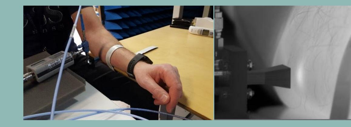
$$\Delta T_{\rm IEEE} = \Delta T_{\rm RAW} \frac{P_{\rm IEEE}}{100 \text{ mW}}$$
