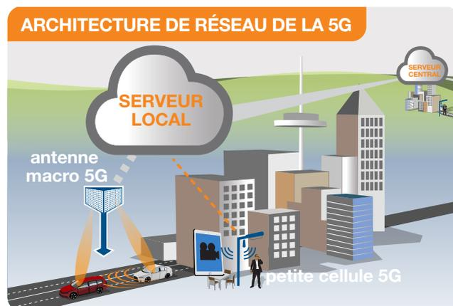
Exemple d'un serveur local dans un réseau 5G offrant une connexion plus rapide et des temps de réponse réduits.
